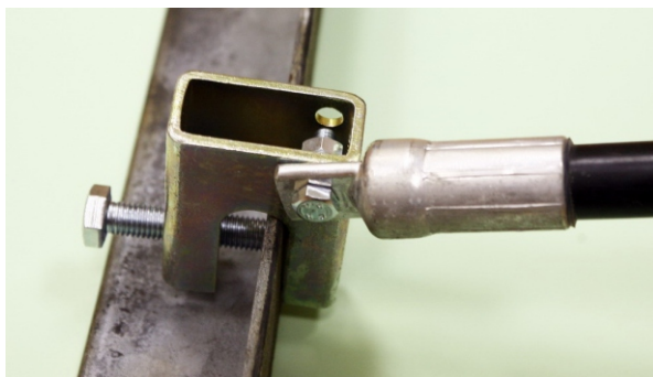
в) крепление разрядника непосредственно к струбцине
