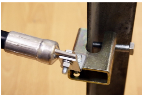
б) крепление разрядника к дополнительному уголку на струбцине
